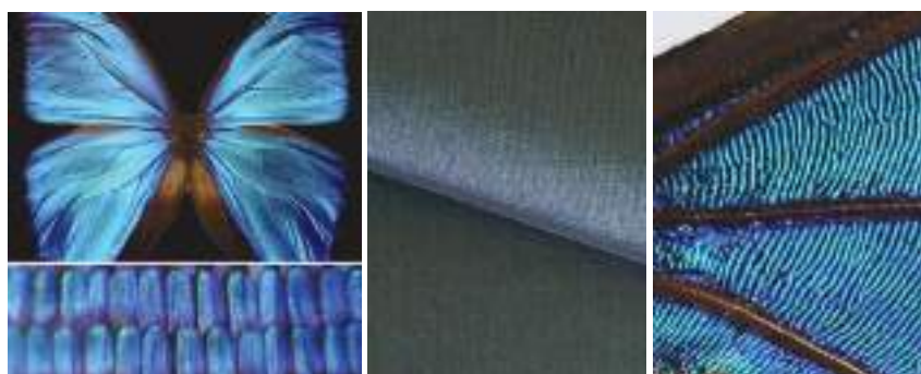
Figura 7 - Tejido Morphotex ® en comparación de la estructura de la mariposa mimética
